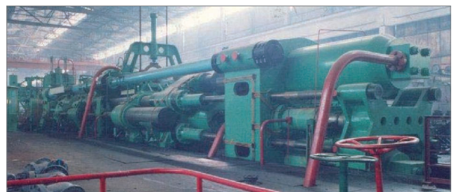
图 3 国内首条 125MN 水压双动铝挤压生产线
